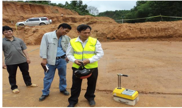
THÍ NGHIỆM ĐỘ CHẶT VÀ ĐỘ ẨM BẰNG MÁY ĐO PHÓNG XẠ TẠI DỰ ÁN ĐƯỜNG CAO TỐC NỘI BÀI - LÀO CAI GÓI THẦU A5
