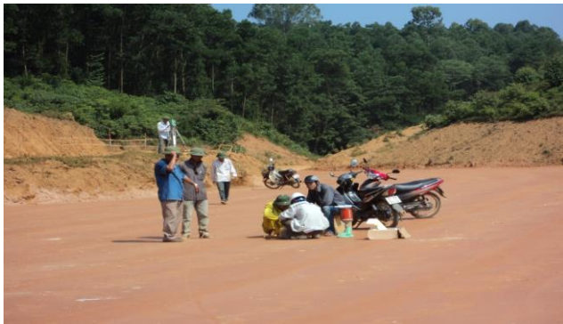
THÍ NGHIỆM ĐỘ CHẶT HIỆN TRƯỜNG BẰNG PP RÓT CÁT TẠI DỰ ÁN ĐƯỜNG CAO TỐC NỘI BÀI - LÀO CAI GÓI THẦU A5
