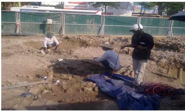
KIỂM TRA CHẤT LƯỢNG CỌC KHOAN NHỒI BẰNG PHƯƠNG PHÁP SIÊU ÂM TẠI DỰ ÁN CẦU VƯỢT NGUYỄN CHÍ THANH
