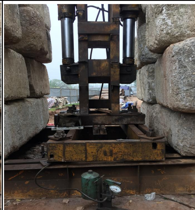
THÍ NGHIỆM SỨC CHỊU TẢI CỦA CỌC BẰNG PP NÉN TĨNH TẠI CẦU VƯỢT AN DƯƠNG
